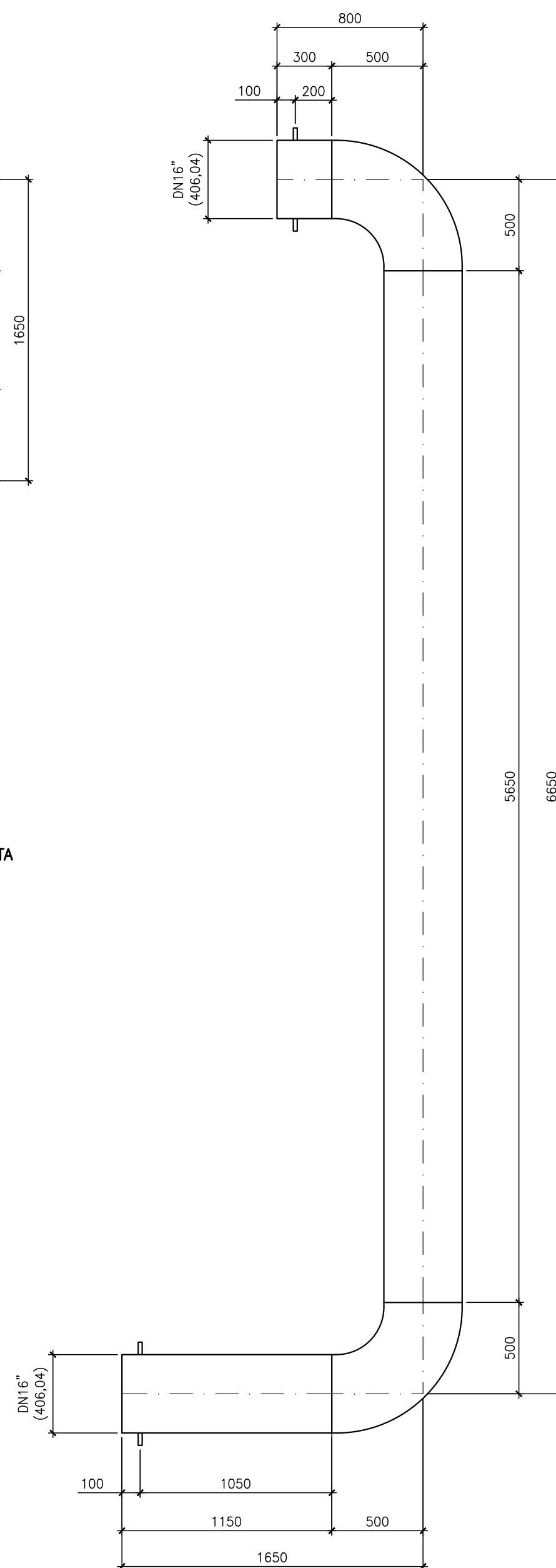
PEÇA 08 MANIFOLD DE INTERLIGAÇÃO DA DIVISÃO DE ÁGUA COAGULADA DO PARSHALL PARA O FLOCULADOR 02 EXISTENTE COM PONTA E ABA DE VEDAÇÃO, PN-10, DN400 (16") ESC. 1:25 (Dimensões em mm)
